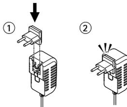
バッテリーチャージャーをバッテリーに取り付け(下の図を参照)、コンセントに接続します。
