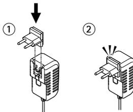
Schließen Sie (wie unten dargestellt) das Batterieladegerät an die Batterie an und stecken Sie es in die Steckdose.
